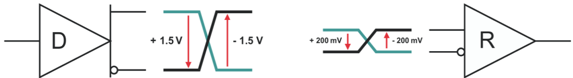
Рисунок 3.9. Мінімальні рівні сигналу шини, зазначені для RS-485
