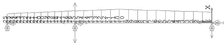
Рисунок 3 - Скінчено-елементна модель бортового перекриття із прикладеним навантаженням
