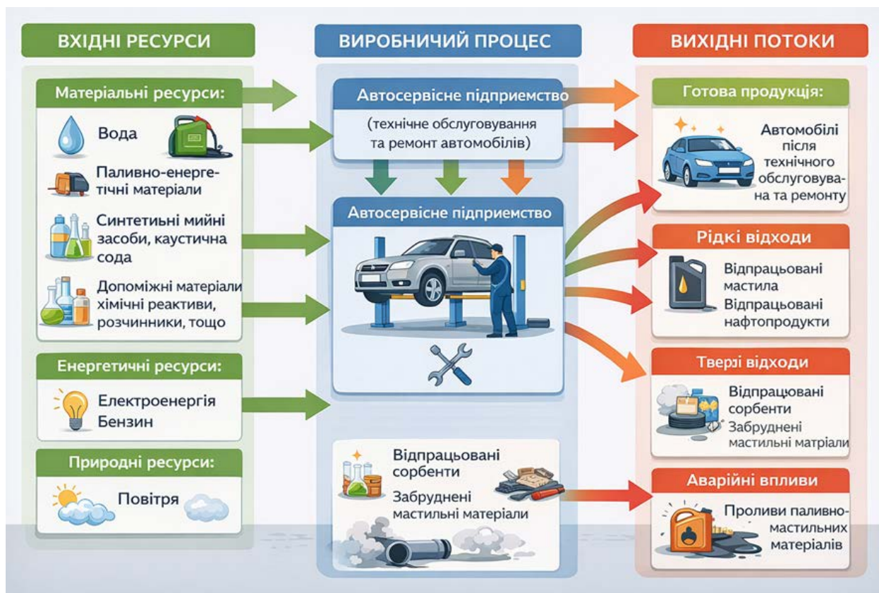
Рисунок 3.2. Схема аналізу життєвого циклу автосервісного підприємства
