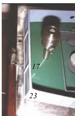
Рис. 7. Стрижні моделі (16, 17) для її поздовжньої орієнтації у резервуарі (22, 23 – направляючі резервуара для орієнтації моделі, 24 – опора розбірного інклінометра великих кутів крену моделі)
