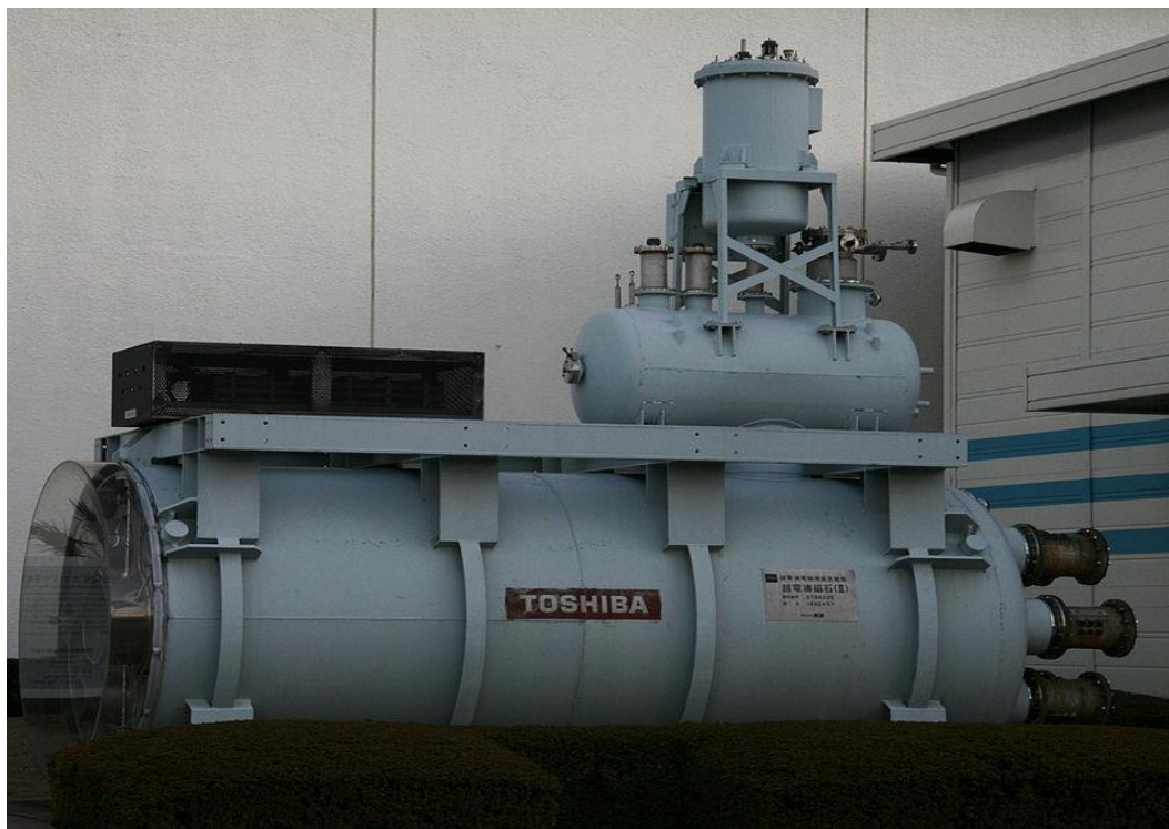
Рисунок 1.12 –Магнітогідродинамічний двигун судна«Ямато-1» в музеї морської науки в Токіо
