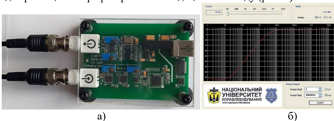
Рисунок 1 – Зовнішній вигляд (а) пристрою для зняття частотних характеристик та інтерфейс програмного забезпечення (б) для його використання
