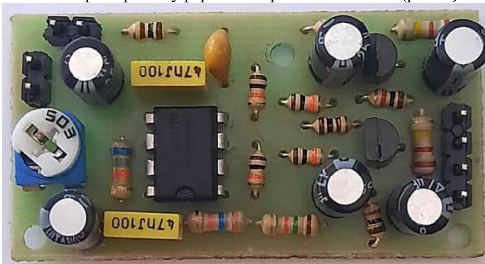
Рисунок 4 – Зовнішній вигляд фільтру сабвуфера на мікросхемі NE5532
