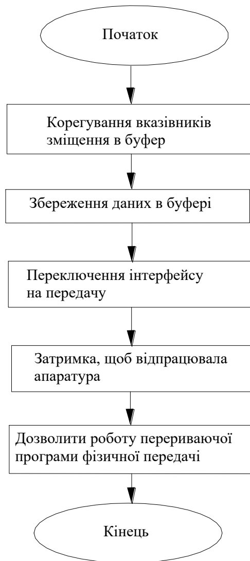
Рисунок 3.6 – Блок-схема функції TransmitByte
