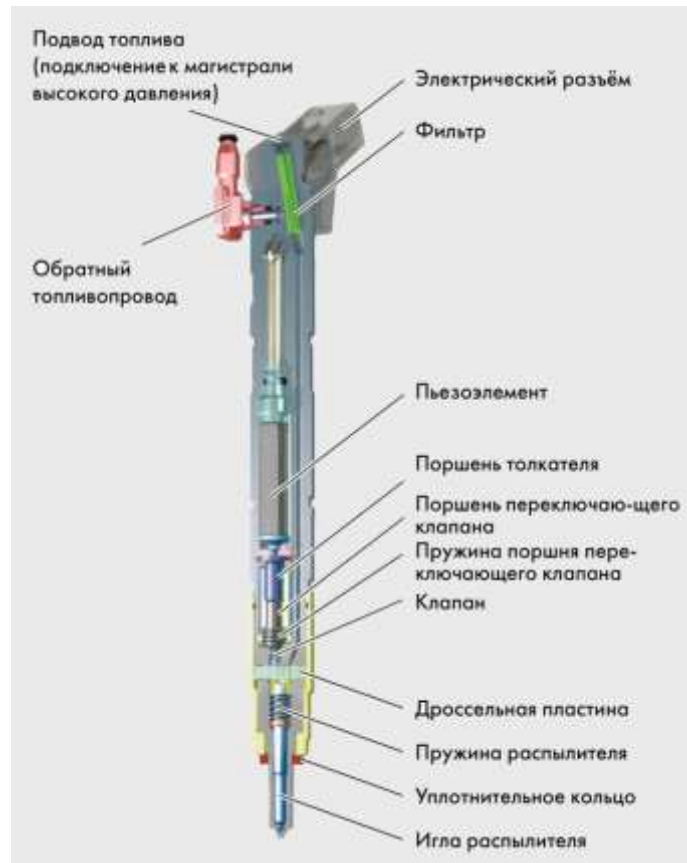
Рис. 3.3 – Форсунка системы Common Rail
