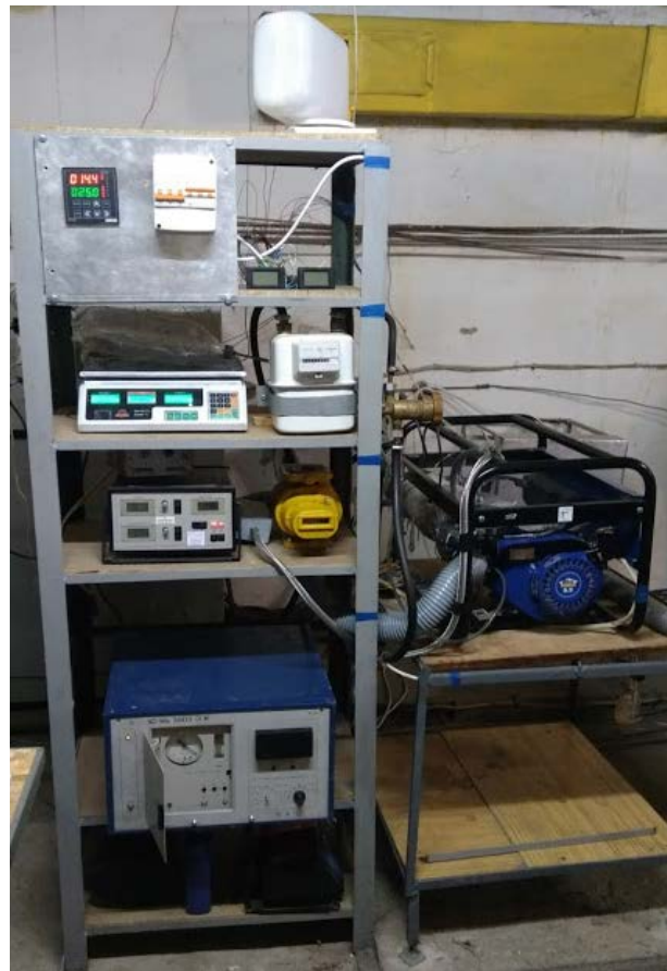
Рис. 1. Загальний вигляд експериментального стенда на базі двигуна з іскровим запалюванням 1Ч 6,8/5,4
