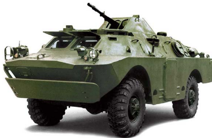
Рис. 1.2. Передсерійна БРДМ-2 озброєння на вежі БПУ-1
