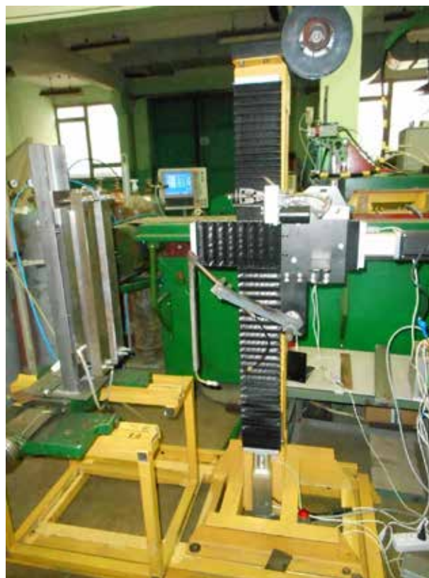
Рис. 1. Зовнішній вигляд лабораторного стенду для лазерного зварювання з'єднань з тонколистових нержавіючих сталей
