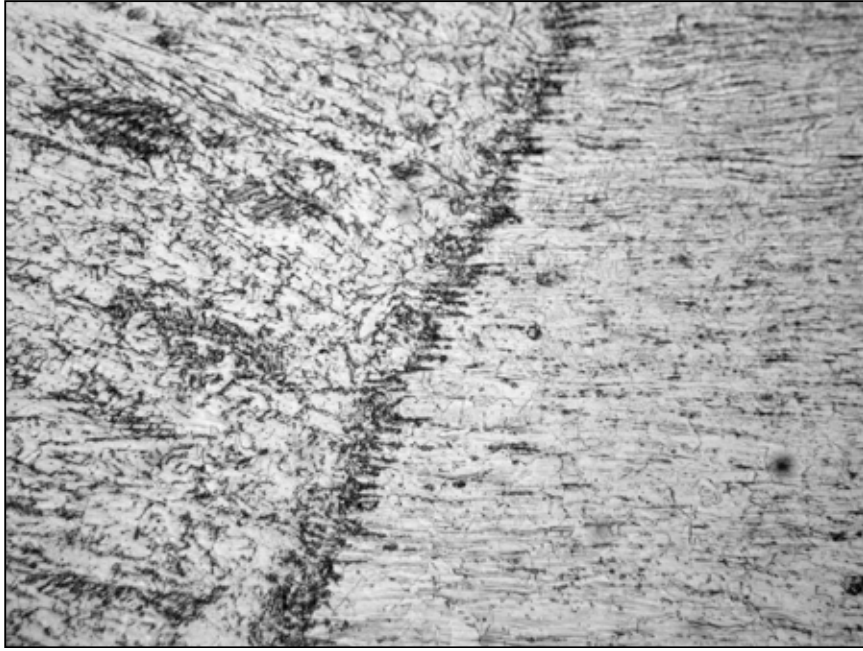
Рис. 7. Фотографія мікроструктури в області лінії сплавлення у верхній частині напусткового зварного з'єднання № 1362.1, \times 400
