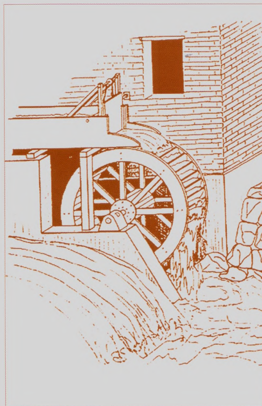
Мал. 3.7. Переливне колесо, що використовувалося для приводу механізмів
