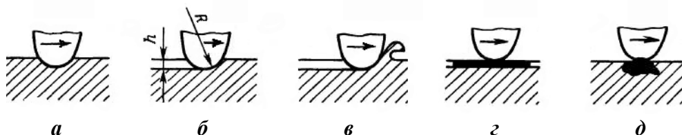
Рис. 1.1. Схема механического контакта отдельной микронеровности с контртелом
