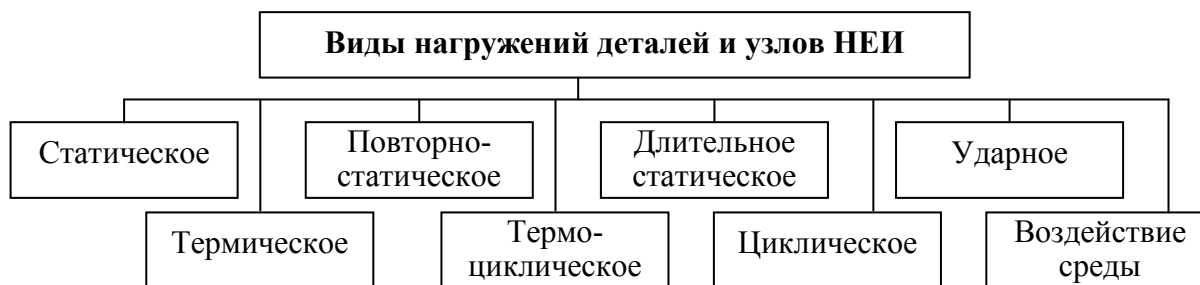
Рис. 2.20. Виды нагружений деталей и узлов НЕИ
