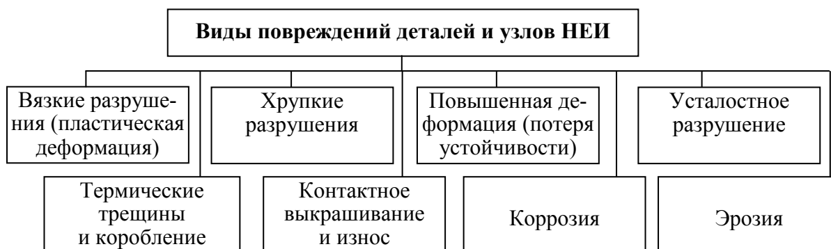
Рис. 2.21. Виды повреждений деталей и узлов НЕИ
