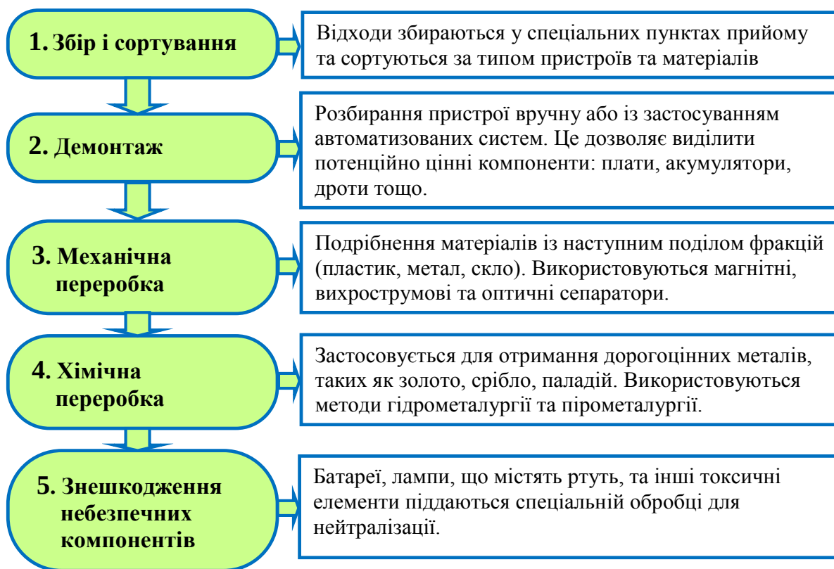
Рис. 2.1. Ключові етапи процесу переробки електронних відходів
