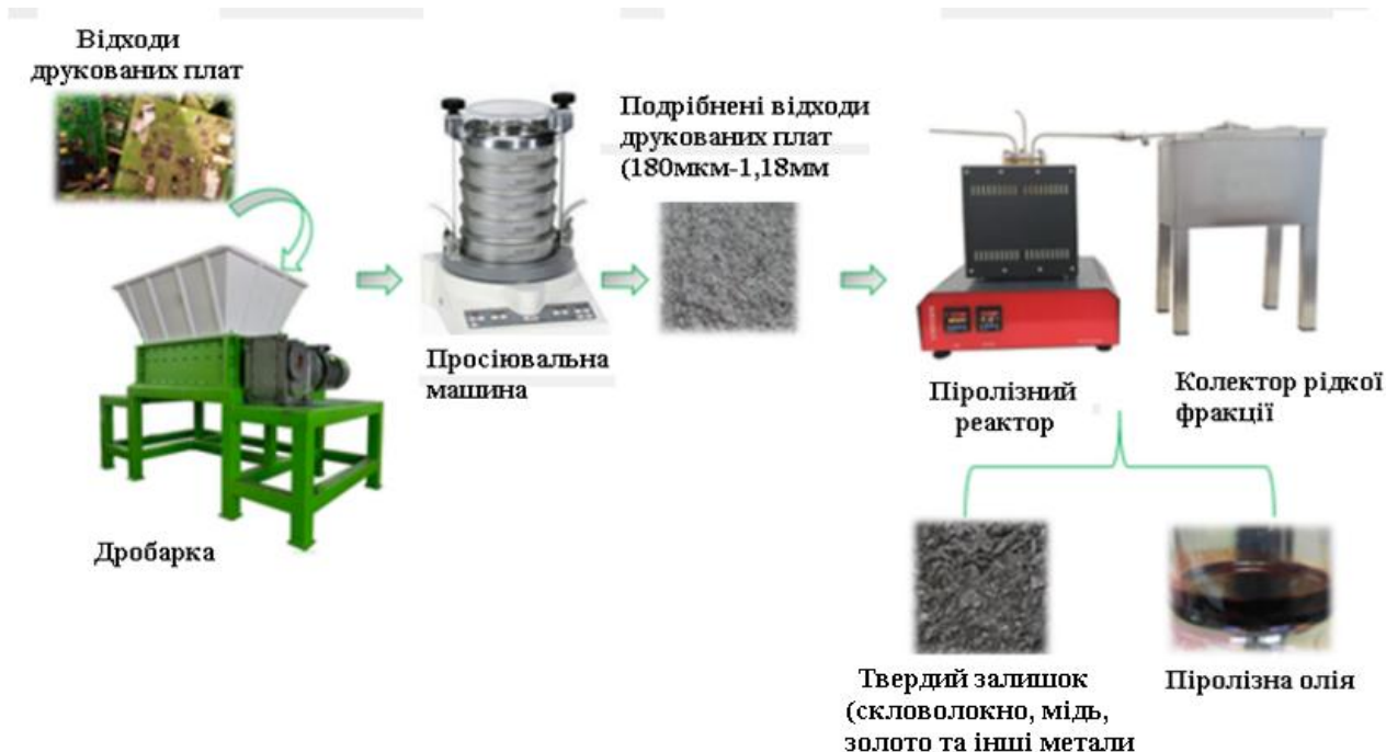
Рис. 3.8. Потік процесу піролізу розкладання й відокремлення твердого джерела металів та летких фракцій
