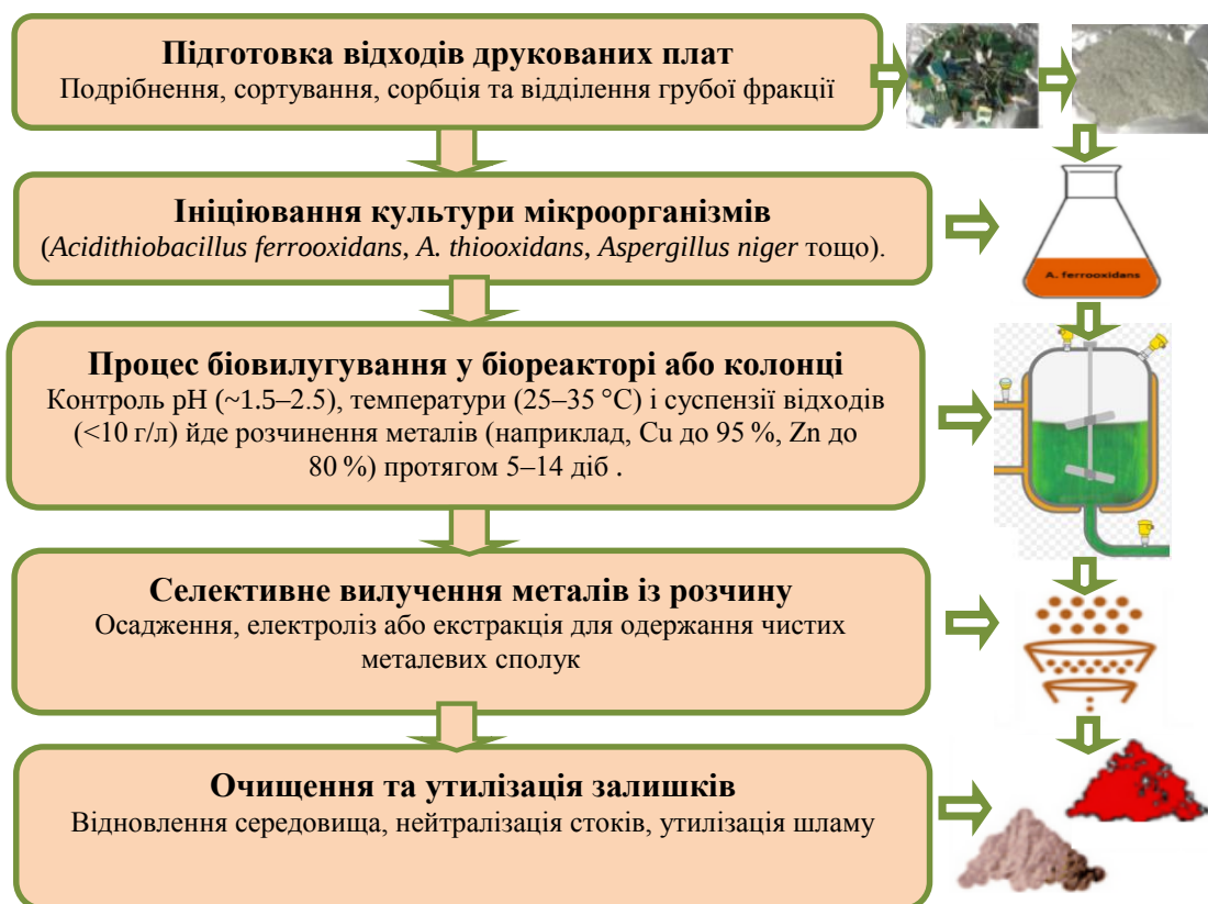
Рис. 3.11. Схематичне зображення процесу біовилугування
