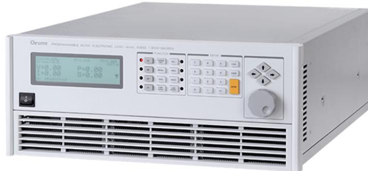
Рисунок 1.2 – Модель 63802 (1.8 кВт / 18 А / 350 В)
