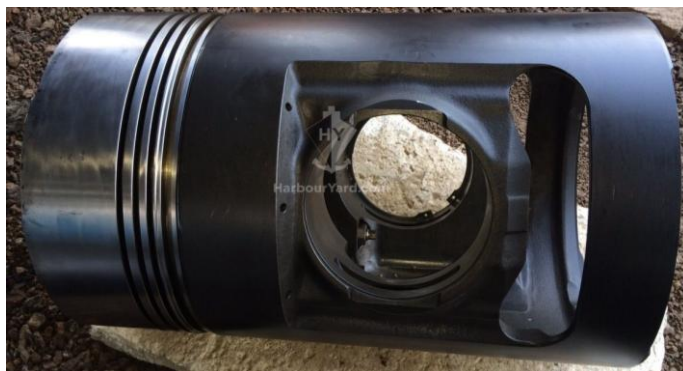
Рисунок 1.6 – Поршень суднового дизеля 8ЧН 51/60 (8L51/60)
