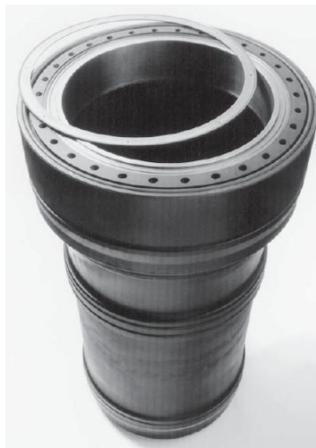
Рисунок 1.4 – Циліндрова втулка дизеля 8ЧН 51/60 (8L51/60)
