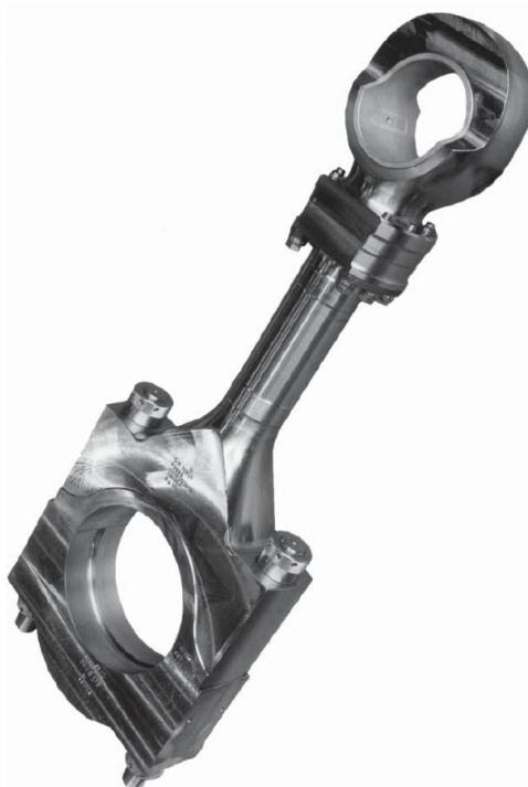
Рисунок 1.2 – Шатун суднового дизеля 8ЧН 51/60 (8L51/60)
