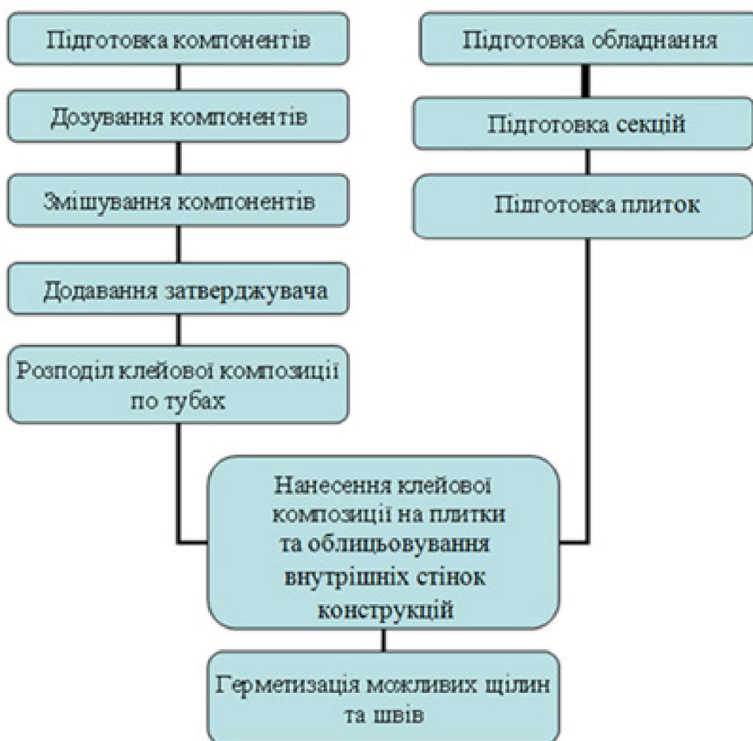
Рис. 3. Технологічна схема формування нероз'ємного з'єднання при виготовленні шаруватих конструкцій модульного типу
