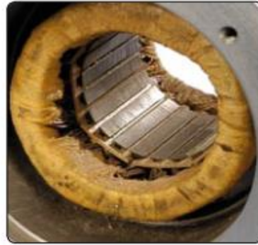
Статор з покращеною ізоляцією
