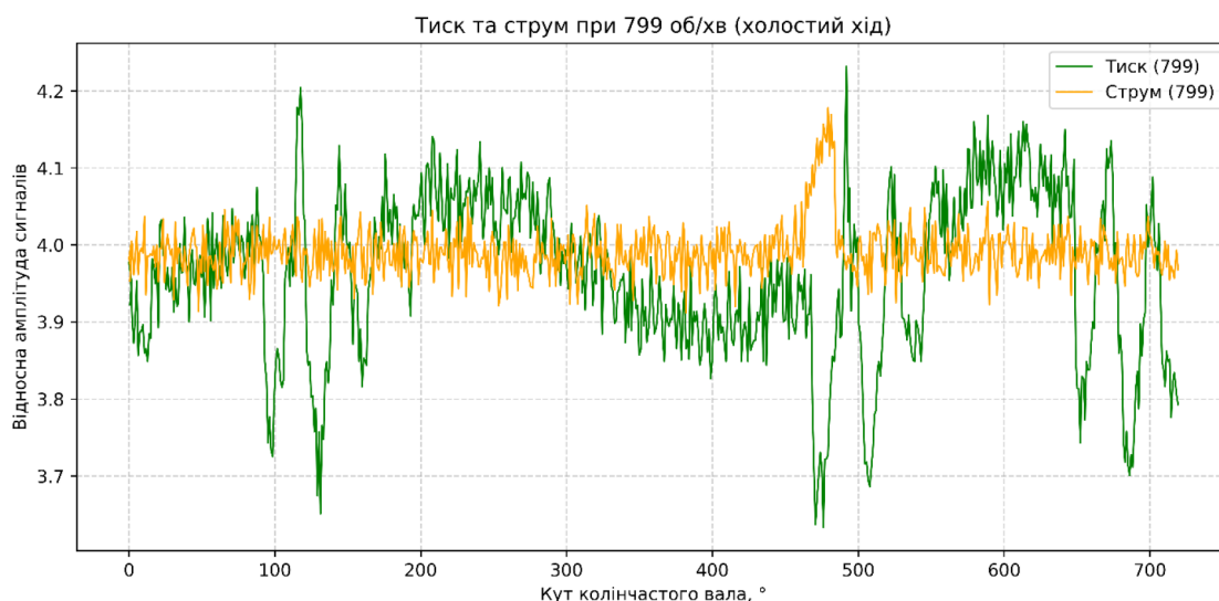
Рис. 5. Сигнал тиску при відключенні форсунки на холостому ході
