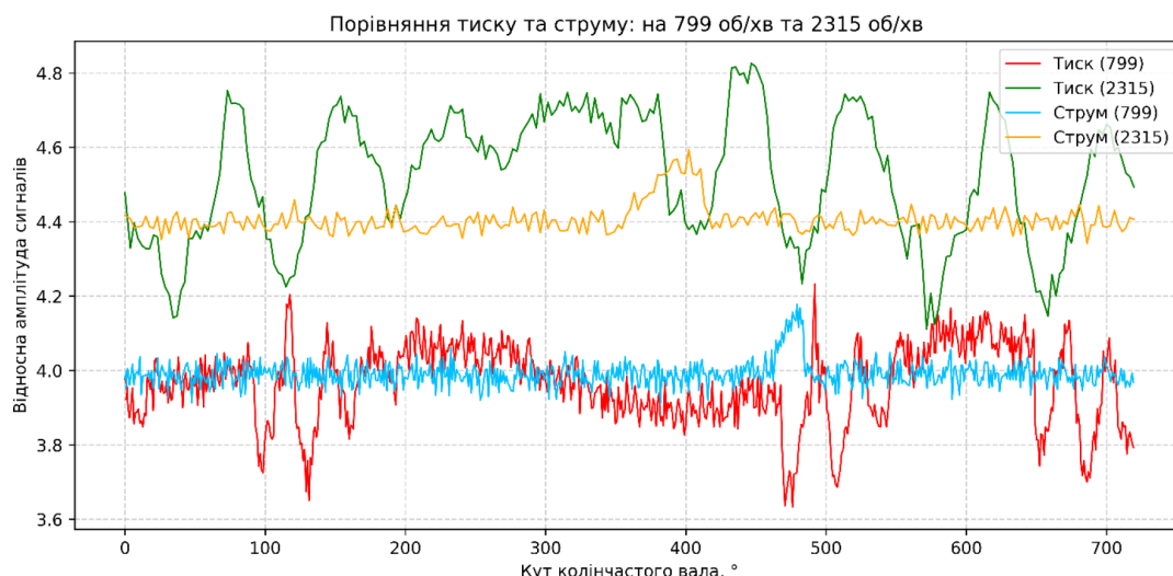
Рис. 7. Графік порівняння сигналів тиску та струму з вимкненою форсункою
