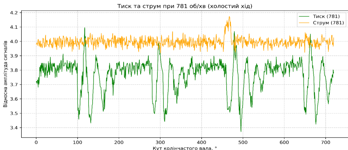
Рис. 2. Сигнал тиску у паливній рампі на холостому ході
