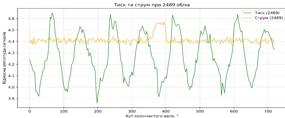
Рис. 3. Сигнал тиску у паливній рампі при середньому навантаженні
