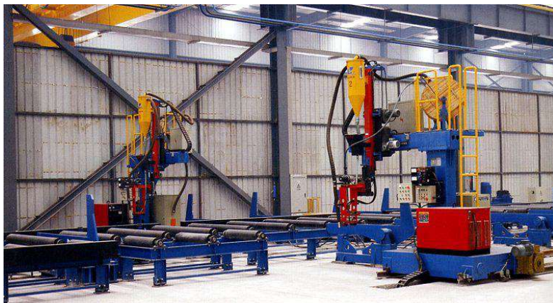
Рис. 2.13. Общий вид портальной автоматической установки для сварки под флюсом крупных балок
