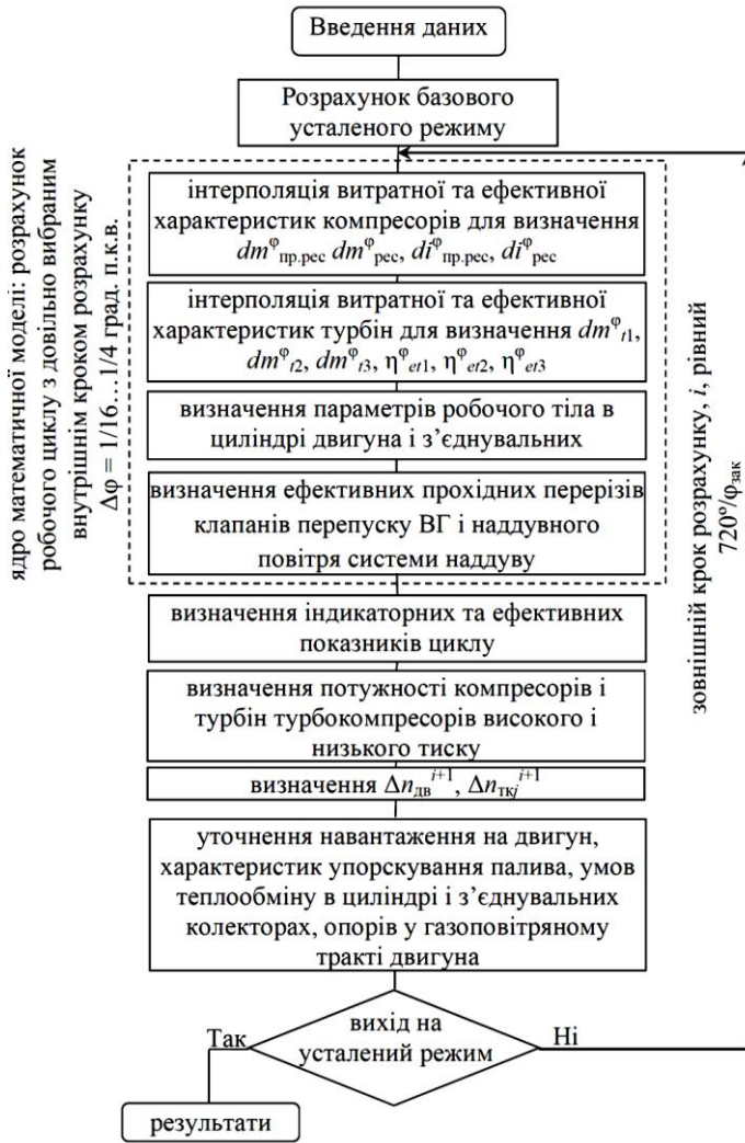
Рис. 5. Блок-схема математичної моделі для розрахунку неусталених режимів роботи двигуна з газотурбінним наддувом
