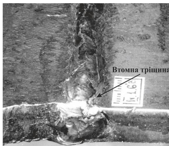
Рисунок Б.1.1 – Вузол перетину поясків рівновеликих балок:
