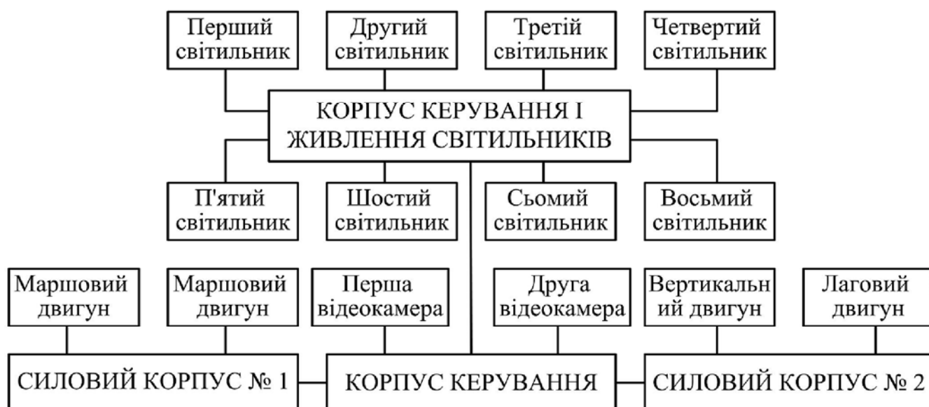
Рисунок 3.5 – Загальна структура електричних споживачів прив'язного підводного апарата
