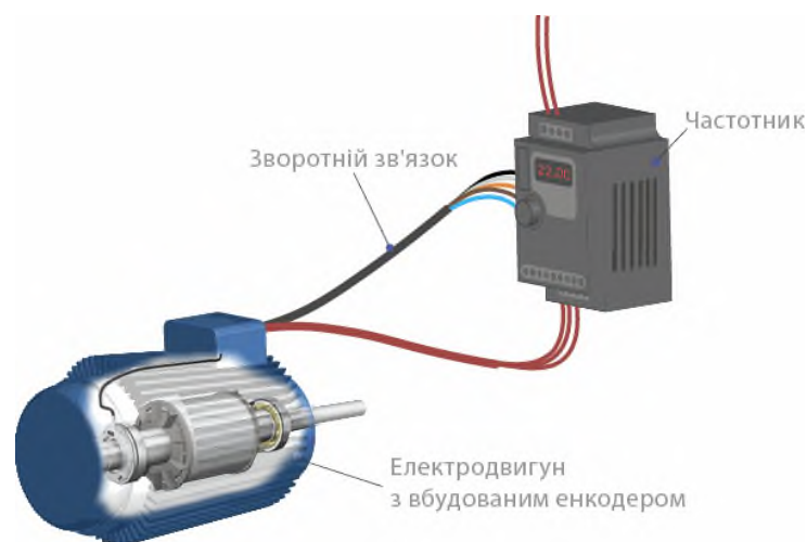
Рисунок 3.6 – Режим керування асинхронним двигуном із закритою петлею векторного контролю
