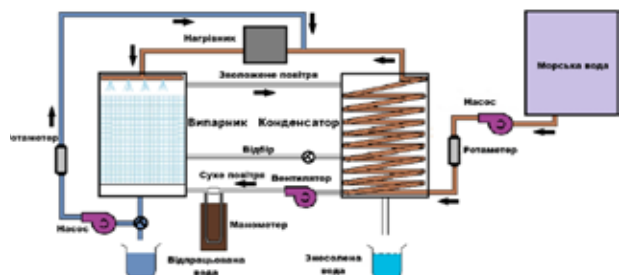
Рис. 5. Схема установки HDH з мідним змійовиком у якості конденсатор
