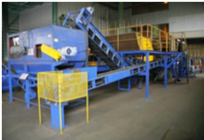
Рис. 4.12. Лінія з подрібнення залишку та його сепарації
