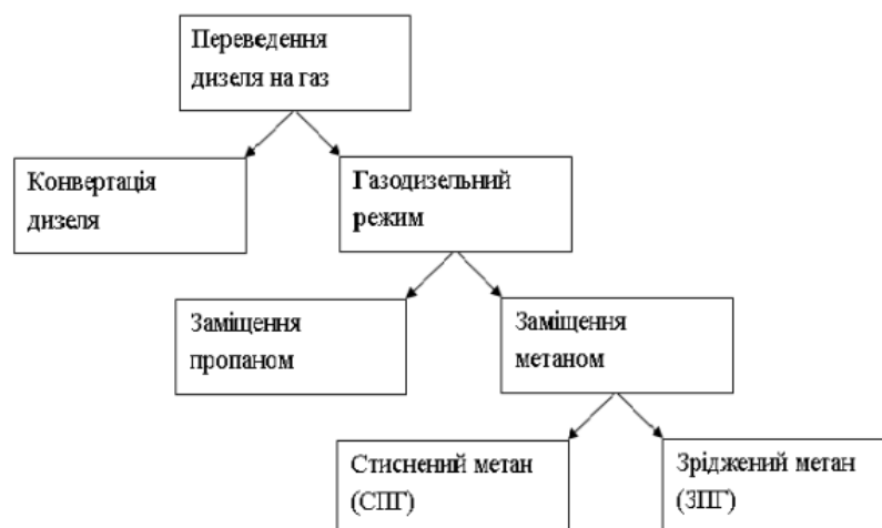
Рисунок 1 - Способи переводу дизельних двигунів на газове паливо
