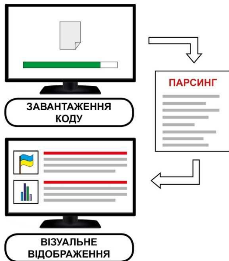
Рисунок 2.7 Принцип роботи front-end
