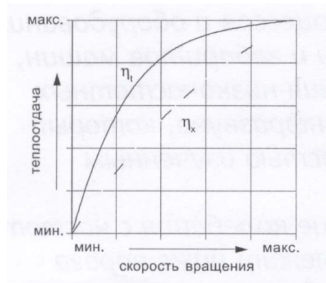
Рис. 4.6 Зміна тепловіддачі обертового регенеративного ТО
