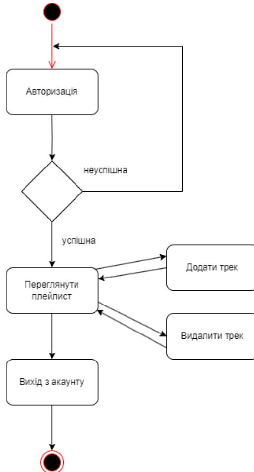
Рисунок 2.7 – Діаграма переходів станів для користувача
