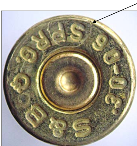
Рис. 3. Денце гільзи із позначенням сліду від виступу сигнального штифта
