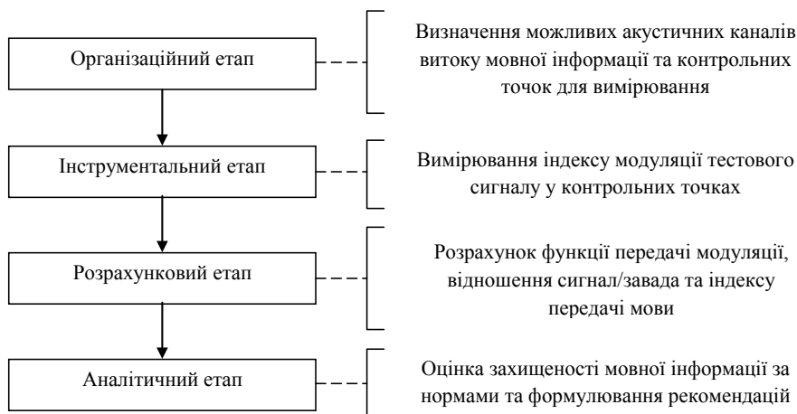
Рисунок 1 – Етапи оцінки акустичної захищеності мови при використанні модуляційних методів
