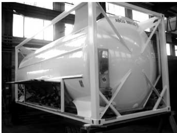
Рисунок 2.2 – Криогенний паливний танк місткістю 125 м 3 СПГ компанії Chart Ferox (Норвегія)
