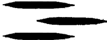
Рис. 7. Трикорпусний тип, або тримаран
