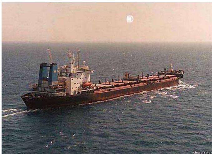
Рис. 3. Балкер "Микола Бажан" (найбільша довжина 215,4 м; найбільша ширина 31,8 м; висота борту до ВЛ 16,95 м; дедвейт 52700 т; дизель, потужність 13700 к. с.; швидкість 15,62 вуз.)
