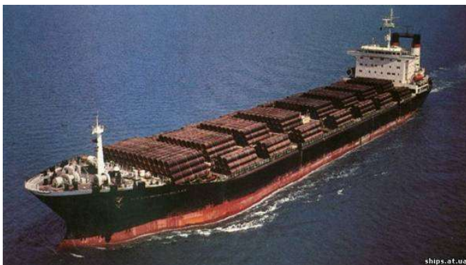
Рис. 2. Балкер "Зоя Космодем'янська" (найбільша довжина 215,4 м; найбільша ширина 31,8 м; висота борта 16,8 м; дедвейт 52700 т; дизель, потужність 13700 к. с.; швидкість 15,76 вуз)
