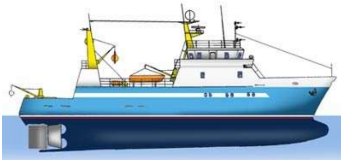
Рис. 4. Сейнер (довжина 38,2 м; ширина 9,6 м; осадка 3,5 м; дедвейт 220 т; потужність головного двигуна 1020 кВт; швидкість повного ходу 12,5 вуз.)
