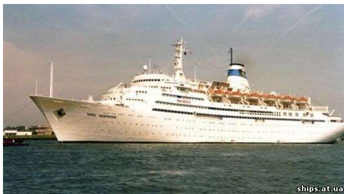
Рис. 1. Лайнер "Тарас Шевченко" (найбільша довжина 176,14 м; найбільша ширина 23,60 м; висота борту 13,50 м; дедвейт 4,240 т; потужність одного двигуна 10500 \times 2 к. с.; швидкість 18 вуз)
