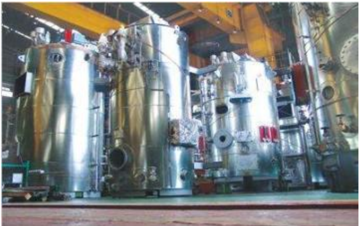
Рис. 4.1. Загальний вигляд котла Kangrim PA
