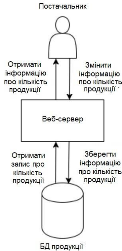
Рис. 17 – Схема логіки роботи системи та зв'язку компонентів для постачальника
