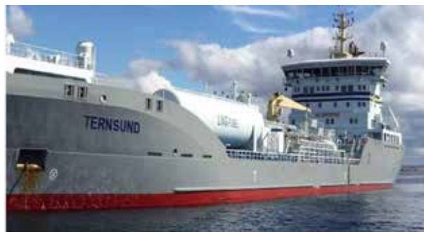
Рис. 3. Розташування газових цистерн на судні
