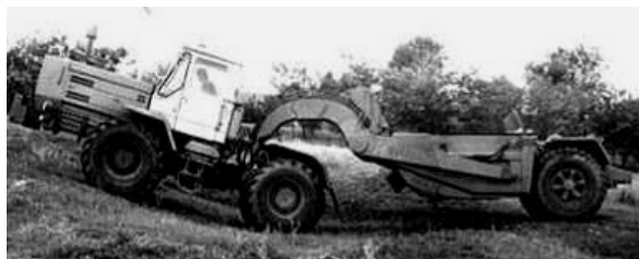
Рис. 13. Скрепер ДЗ-87 з трактором Т-150К (ХТЗ).
