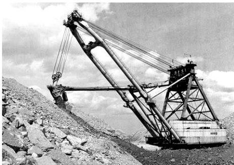
Рис. 7. Вскришний екскаватор-лопата на гусеничному ході ЕВГ-35/65М
