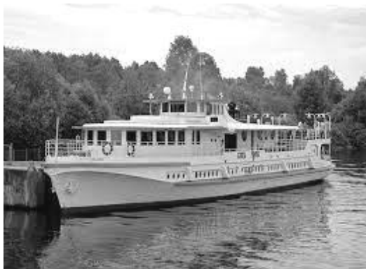
Рис. 16. Пасажирський озерно-річковий теплохід типу «ОМ» (пр. № 780)
