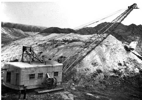
Рис. 6. Екскаватор-драглайн ЕК 4/40 на крокуючому ході
