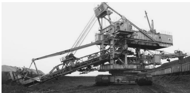
Рис. 8. Роторний екскаватор ЕРП-1600-20-2Ц
