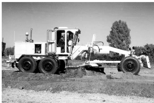
Рис. 12. Автогрейдер типу ДЗк
