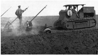
Рис. 27. Трактор "Комунар" моделі Г-50 з причіпним плугом під час оранки
