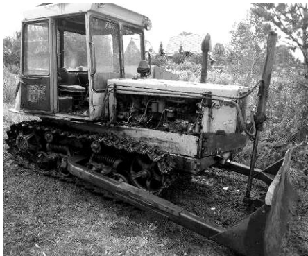
Рис. 14. Бульдозер ДЗ-162 на базі трактора ДТ-75Н
