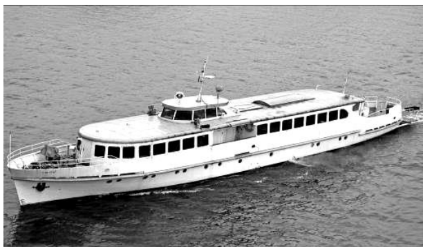
Рис.19. Пасажирський озерно-річковий теплохід для місцевих перевезень проєкту № 839
