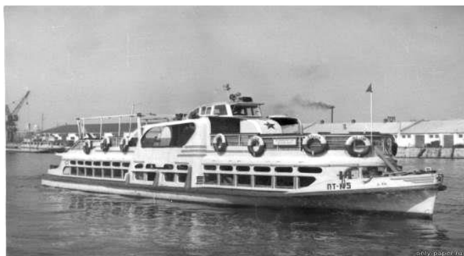
Рис.18. Пасажи́рський річковий теплохі́д для місцевих перевезень проекту №544
