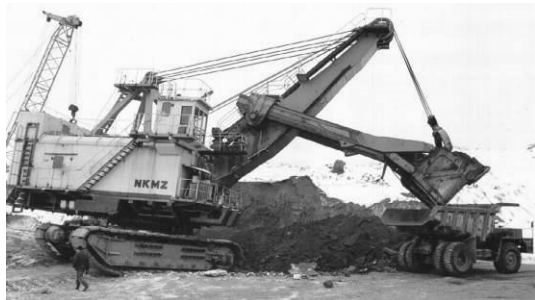
Рис. 10. Екскаватор кар'єрний на гусеничному ході ЕКГ-10Н, з ковшем місткістю 10 м 3
