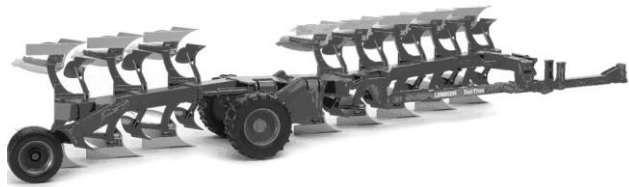
Рис. 28. Напівначіпний оборотний плуг
