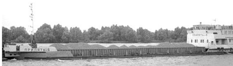
Рис 13. Суховантажний теплохід проекту № 998АК
