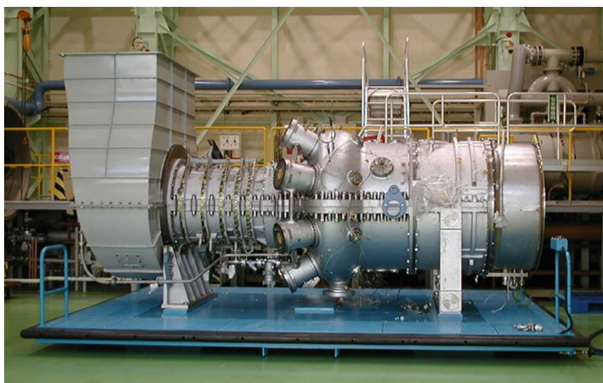
Рис. 5.16. Двигун L20A компанії "Kawasaki Heavy Industries, Ltd." з секційною камерою згоряння
