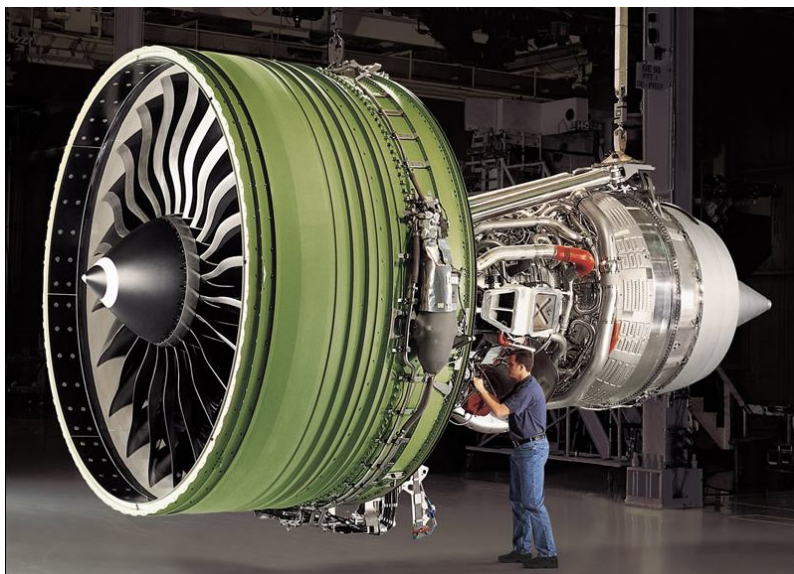
Рис. 27Д. Двоконтурний турбореактивний двигун GE90-115В компанії "General Electric Co." з мірою двоконтурності 10 і максимальною тягою 568 кН
