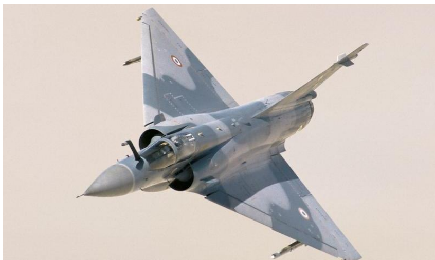
Рис. 17Д. Надзвуковий винищувач "Mirage III" з одним ТРДФ "Atar 09C"
