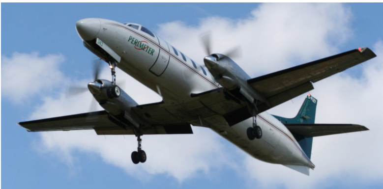
Рис. 23Д. Пасажирський 19-місний бізнес-літак "Metroliner" з двома двигунами TRE331
