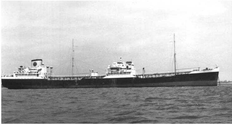
Рис. 3.41. Танкер "Auris" компанії "Anglo-Saxon Petroleum Co. Ltd." водотоннажністю 12000 т (перше комерційне судно з ГТА; з 1951 по 1960 р. на ньому проходили дослідну експлуатацію ЕУ компанії "British Thomson-Houston Co.")
