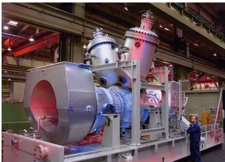
Рис. 5.22. Двигун сімейства "ТНМ" потужністю від 6 до 11 МВт компанії "MAN Diesel & Turbo SE" з індивідуальною двотрубною камерою згоряння [36, с. 163]
