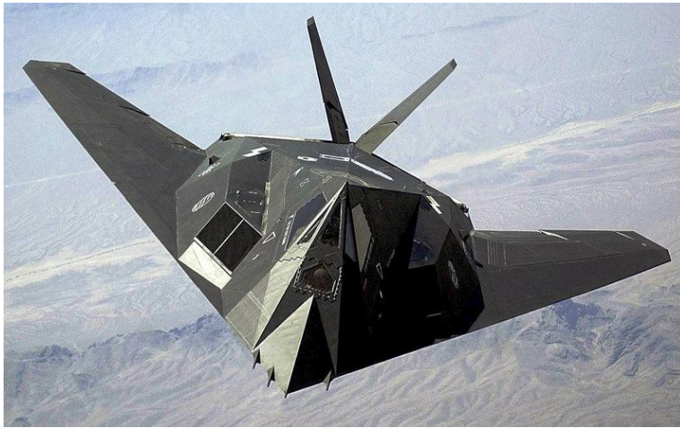
Рис. 3.26. Дозвуковий малопомітний ударний літак F-117 "Nighthawk" з двома ТРДД F404-F1D2 компанії "General Electric Co." максимальною тягою по 48 кН (з 1983 по 1990 р. виготовлено 64 од.; у 2008 р. знято з озброєння)
