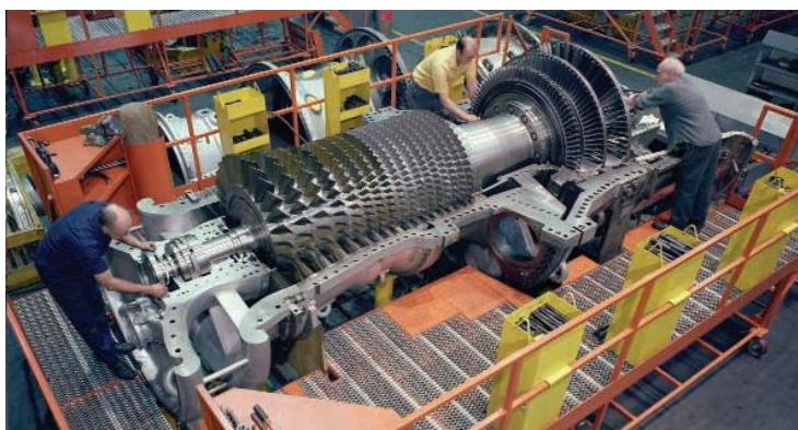
Рис. 4.5. Збирання двигуна MS6001B потужністю 41 МВт компанії "General Electric Co."
