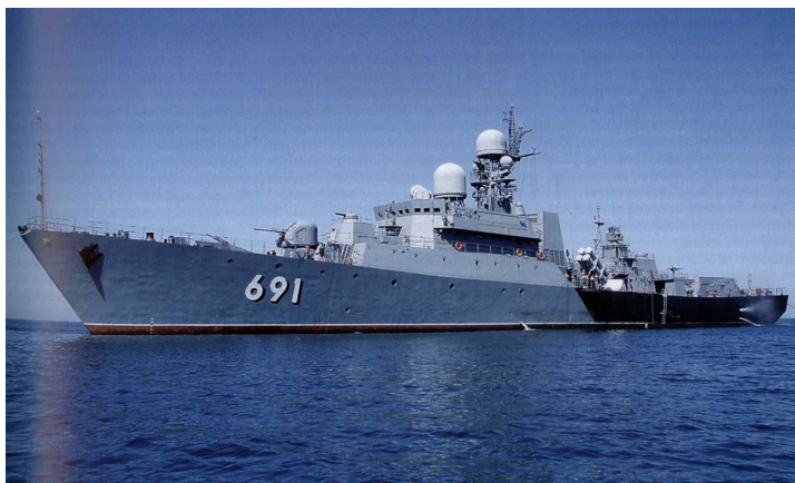
Рис. 3.36. Корвет (малий протичовновий корабель) проекту 1166.1 "Гепард" (ЕУ типу "CODOG": дизель 61Д + 2 \times \text{UGT } 15000 ; повна водотоннажність 1500 т, повна швидкість 28 вуз, введено в дію 4 од.)
