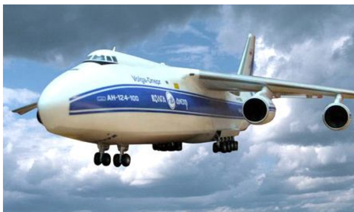
Рис. 3.23. Найбільш вантажопідйомний (до 150 т) серійний транспортний літак у світі Ан-124 "Руслан" з чотирма ТРДД Д-18Т розробки ДП "Івченко-Прогрес" максимальною тягою по 230 кН (з 1984 по 2004 р. виготовлено 55 од.)
