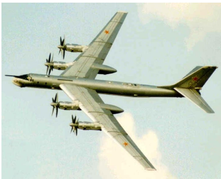
Рис. 3.20. Один із символів "холодної війни" – стратегічний бомбардувальник-ракетоносець Ту-95 з чотирма турбогвинтовими двигунами НК-12М компанії ОАО "Кузнецов" максимальною потужністю по 11 МВт (бомбове навантаження до 12 т; з 1955 по 1992 р. виготовлено більше 500 од.)
