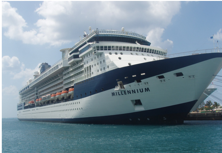
Рис. 3.44. Круїзне судно класу "Millennium" (ЕУ типу "COGES": 2×LM2500+ з теплоутилізаційним контуром; повна водотоннажність 90238 т, швидкість 21 вуз, екіпаж 920 чол., пасажиромісткість 1950 чол., побудовано 4 од.)
