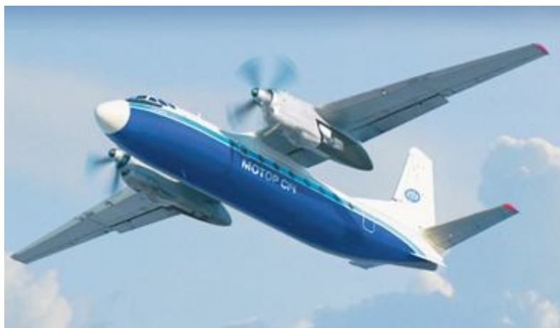
Рис. 3.19. Пасажирський літак Ан-24 з двома турбогвинтовими двигу-нами АИ-24 розробки ДП "Івченко-Прогрес" максимальною потужністю по 1900 кВт (місткість 50 чол., з 1962 по 1979 р. виготовлено 1367 од.)
