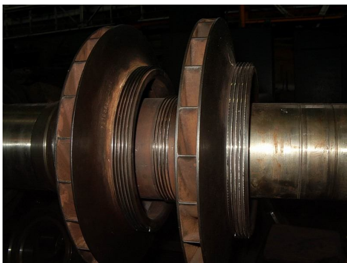
Рис. 4.13. Ротор двоступінчастого промислового відцентрового компресора з колесами закритого типу
