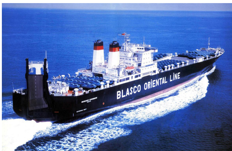
Рис. 3.43. Контейнеровоз проекту 1609 "Атлантика" (ЕУ типу "COGAS": 2×UGT 16000 з теплоутилізаційним контуром; повна водотоннажність 35000 т, повна швидкість 25 вуз, з 1979 по 1987 р. побудовано 4 од.)
