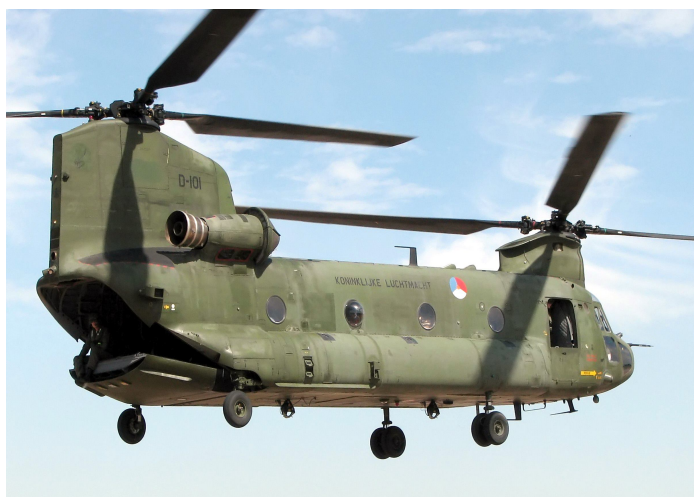
Рис. 3.22. Важкий військово-транспортний вертоліт СН-47 "Chinook" з двома турбовальними двигунами Т-55-Л-714 максимальною потужністю по 3100 кВт компанії "Honeywell International, Inc." (з 1959 по 2013 р. виготовлено 1179 од.)
