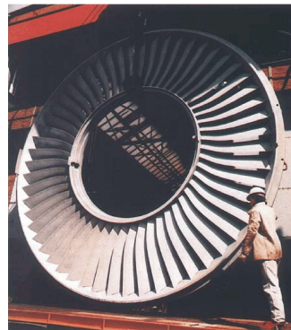
Рис. 6.2. Соплові апарати осових турбін турбореактивного двигуна J47 ( a ) і парової турбіни ( б )
