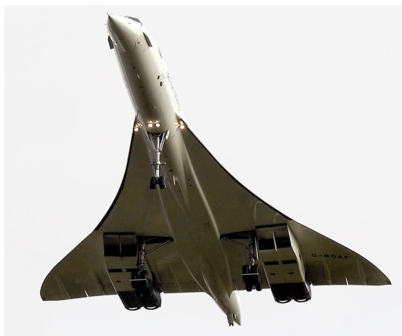
Рис. 3.24. Надзвуковий пасажирський літак "Concorde" з чотирма турбореактивними двигунами "Olympus 593 Mk.610" компанії "Rolls-Royce plc" максимальною тягою по 169 кН (перебував в експлуатації з 1976 по 2003 р.; всього виготовлено 20 од.)
