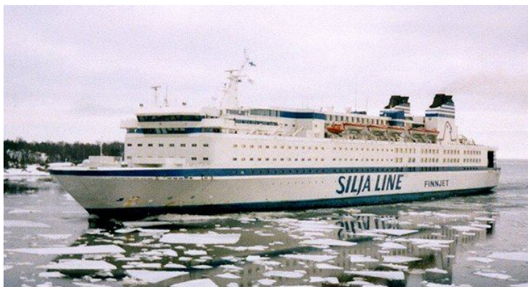
Рис. 3.42. Круїзне судно-пором "Finnjet" (перше пасажирське судно з ГТА; побудоване у 1977 р. для сполучення між Фінляндією та Німеччиною; ЕУ: 2×FT4C-1DLF компанії "Pratt & Whitney Corp."; повна водотоннажність 24605 т, швидкість 31 вуз, екіпаж 178 чол., пасажиромісткість 1780 чол.)
