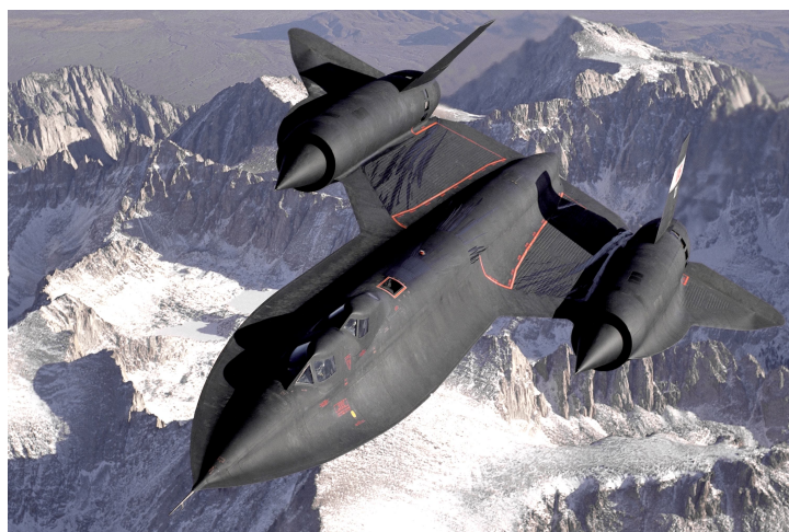
Рис. 3.25. Стратегічний надзвуковий літак-розвідник SR-71 "Blackbird" компанії "Lockheed Corp." з двома турбореактивними двигунами J58-1 компанії "Pratt & Whitney Corp." максимальною тягою по 151 кН (з 1966 по 1998 р. виготовлено 32 од., 12 з них втрачено внаслідок нещасних випадків)
