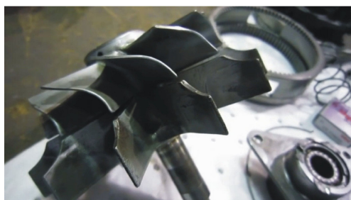
Рис. 6.18. Турбодетандер ( а ) системи запуску авіаційного двигуна та його робоче колесо ( б )
