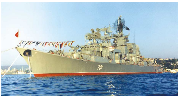
Рис. 3.35. Великий протичовновий корабель проекту 1134Б "Беркут-Б" (ЕУ типу "COGAG": 2 \times \text{UGT } 6000 + 4 \times \text{UGT } 16000 ; повна водотоннажність 8900 т, повна швидкість 32 вуз, введено в дію 7 од.)
