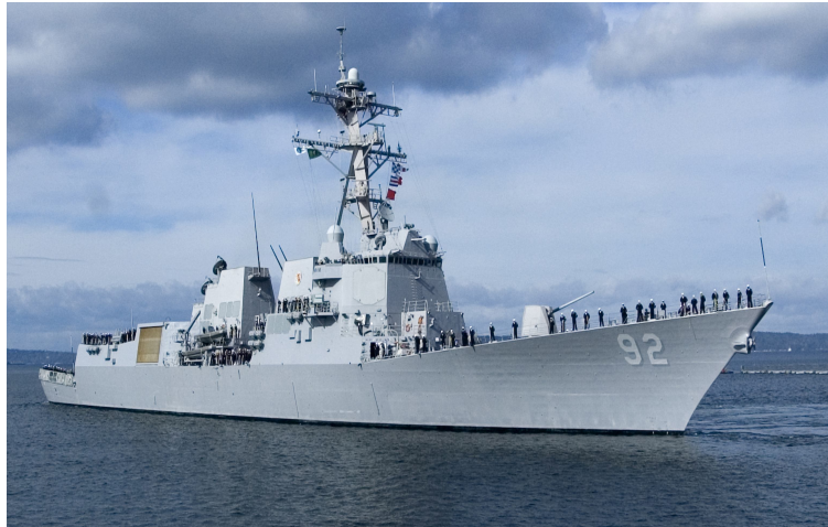
Рис. 3.38. Ракетний есмінець класу "Arleigh Burke" (ЕУ типу "COGAG": 4×LM2500; повна водотоннажність 8315 т, повна швидкість 30 вуз, введено в дію 62 од.)
