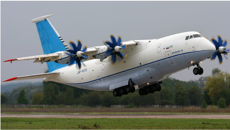
Рис. 36Д. Транспортний літак Ан-70 з чотирма двигунами Д-27
