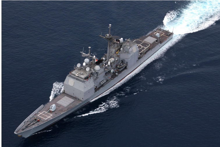
Рис. 3.37. Ракетний крейсер класу "Ticonderoga" (ЕУ типу "COGAG": 4×LM2500; повна водотоннажність 9800 т, повна швидкість 32 вуз, введено в дію 27 од.)
