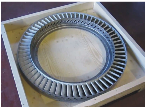
Рис. 6.2. Соплові апарати осових турбін турбореактивного двигуна J47 ( a ) і парової турбіни ( б )
