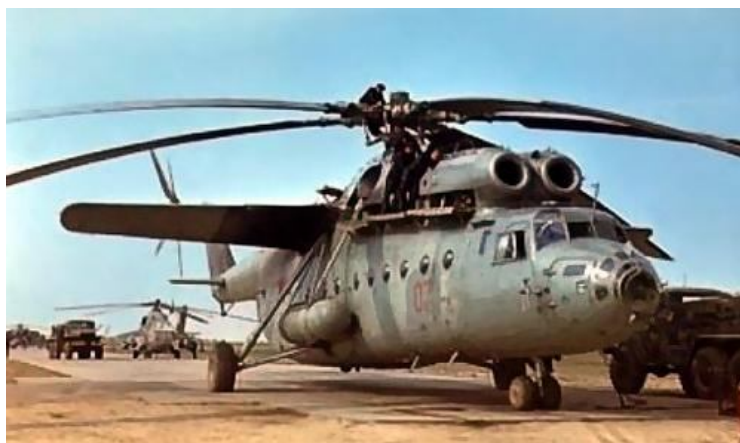
Рис. 3.21. Важкий багатоцільовий вертоліт Ми-6 з двома турбовальними двигунами Д-25В максимальною потужністю по 4100 кВт розробки ОАО "Авиадвигатель" (перший радянський вертоліт з ГТД; з 1959 по 1980 р. виготовлено 926 од.)
