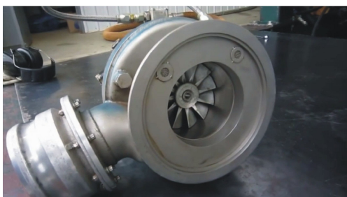
Рис. 6.18. Турбодетандер ( а ) системи запуску авіаційного двигуна та його робоче колесо ( б )
