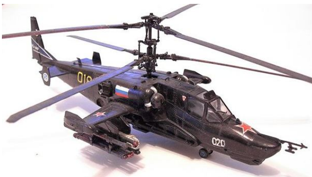
Рис. 39Д. Бойовий вертоліт Ка-50 "Черная акула" з двома двигунами ТВ3-117ВМА
