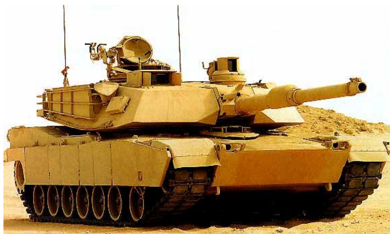
Рис. 3.33. Танк М1 "Abrams" з двигуном AGT1500 потужністю 1120 кВт компанії "Honeywell International, Inc." (бойова маса 62 т, екіпаж 4 чол., довжина 7,92 м, довжина з гарматою вперед 9,77 м, ширина 3,66 м, висота 2,89 м, швидкість по шосе 67 км/год, запас ходу по шосе 410 км)
