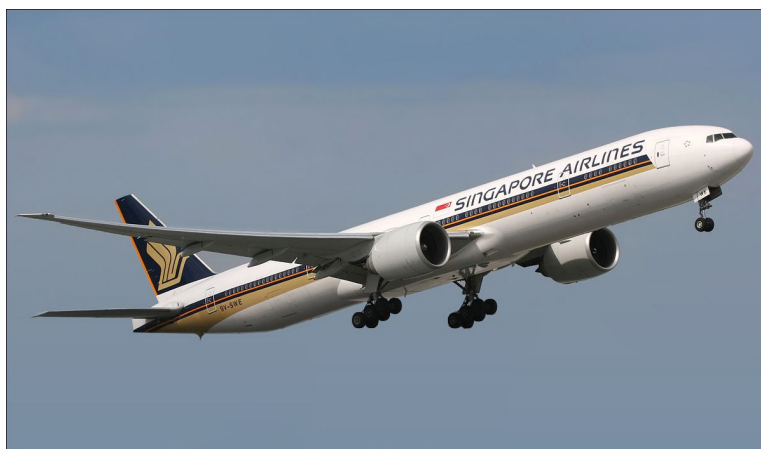
Рис. 28Д. Пасажирський літак "Boeing 777-312ER" з двома двигунами GE90
