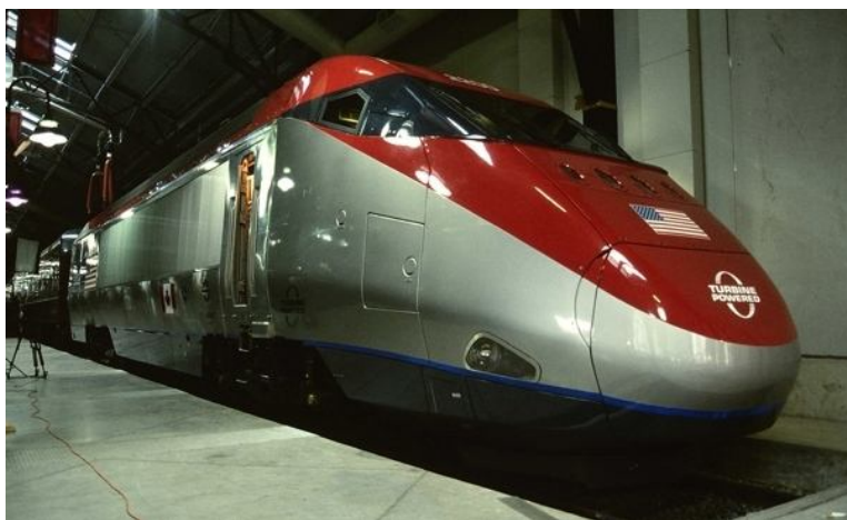
Рис. 3.28. Локомотив "JetTrain" компанії "Bombardier Inc." з газотурбінною установкою потужністю 4 МВт компанії "Pratt & Whitney Corp."
