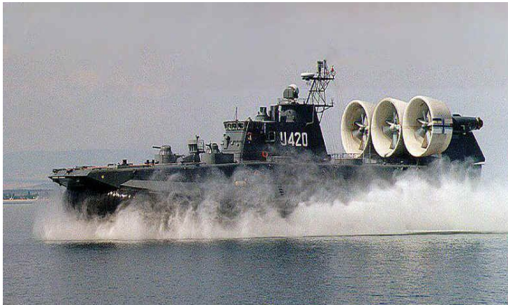
Рис. 3.39. Десантний корабель на повітряній подушці проекту 1232.2 "Зубр" (ЕУ: 5×UGT 6000; повна водотоннажність 555 т, повна швидкість 63 вуз, введено в дію 14 од.)
