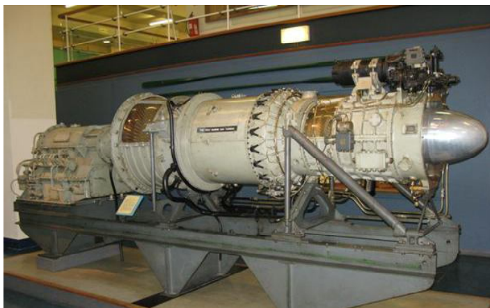
Рис. 3.34. Артилерійський катер MGB 2009 (водотоннажність 95 т; максимальна швидкість 31 вуз; ЕУ: два бензинових двигуни по 1 МВт + один ГТД) ( а ) і його газотурбінний двигун G.1 "Gatric" ( б )
