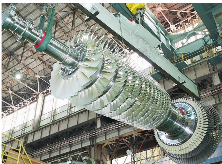
Рис. 4.4. Ротор двигуна M501G потужністю 264 МВт компанії "Mitsubishi Heavy Industries, Ltd."
