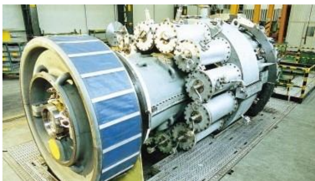
Рис. 5.15. Двигун MS5002C компанії "General Electric Co." з секційною камерою згоряння
