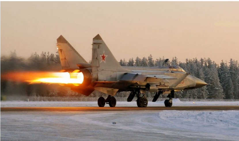
Рис. 33Д. Зліт винищувача МиГ-31 (два ТРДДФ Д-30Ф6 компанії ОАО "Авиадвигатель") з працюючими форсажними камерами
