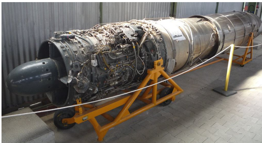
Рис. 16Д. Турбореактивний двигун з форсажною камерою згоряння "Atar 101G" компанії "SNECMA" (максимальна тяга 46 кН)
