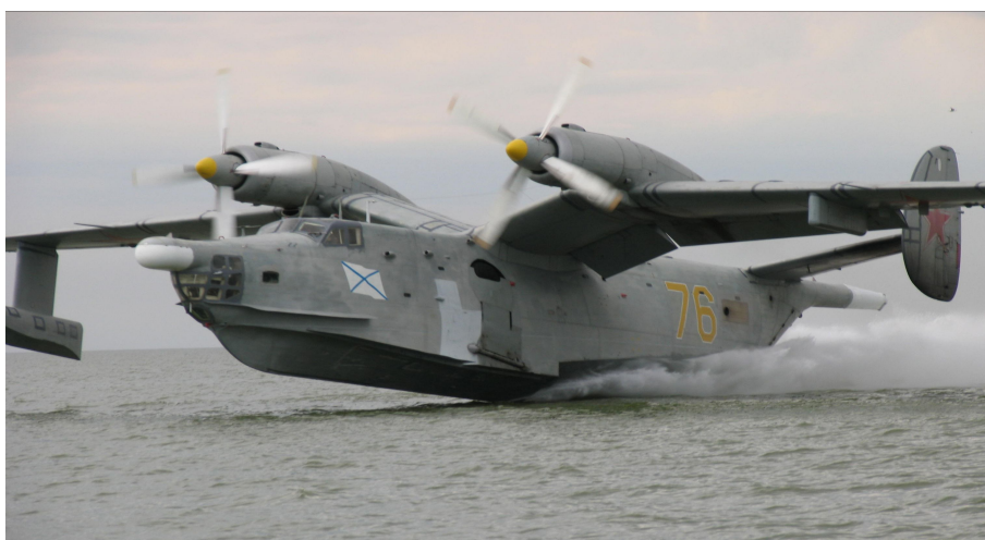
Рис. 21Д. Протичовновий літак-амфібія Бе-12 з двома двигунами АІ-20
