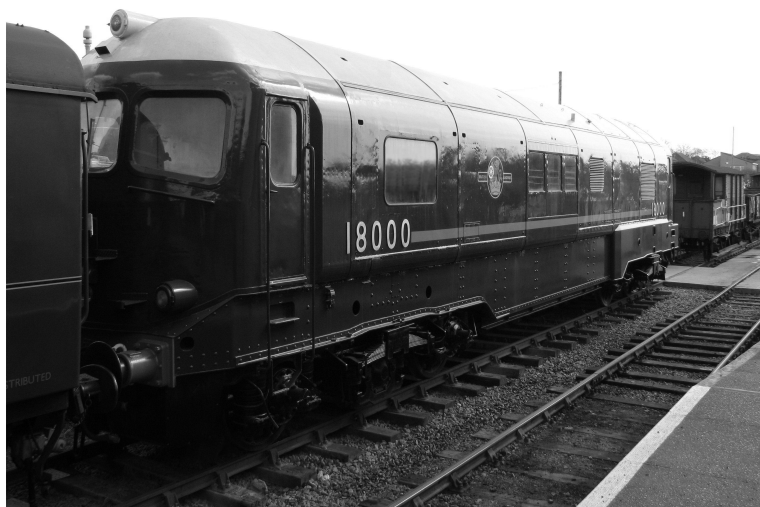
Рис. 3.27. Локомотив "18000" з електроенергетичною газотурбінною установкою постійного струму потужністю 1900 кВт компанії "Brown, Boveri & Cie" (1949 р.)
