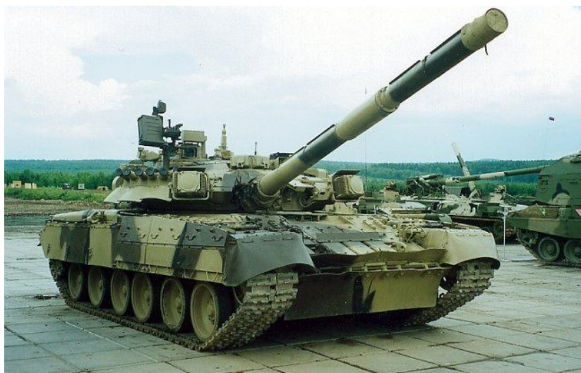
Рис. 3.32. Танк Т-80У з двигуном ГТД-1250 потужністю 930 кВт компанії ОАО "Климов" (бойова маса 46 т, екіпаж 3 чол., довжина 6,98 м, довжина з гарматою вперед 9,65 м, ширина 3,53 м, висота 2,19 м, швидкість по шосе 70 км/год, запас ходу по шосе 350 км)
