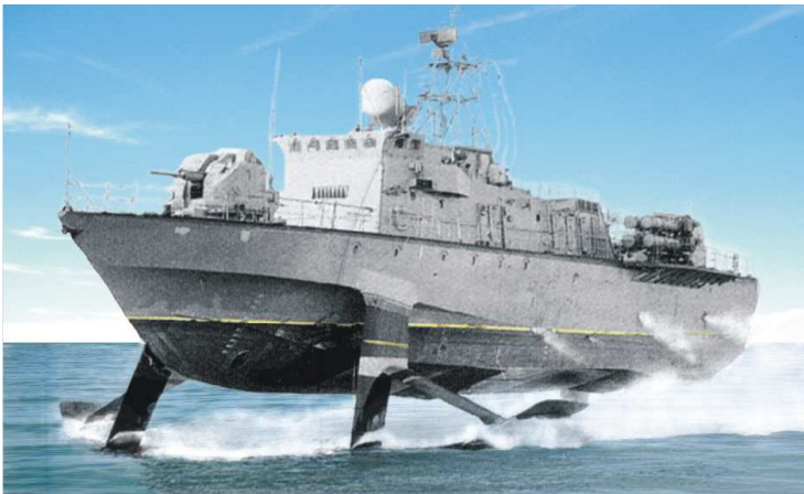
Рис. 3.40. Малий протичовновий корабель на підводних крилах проекту 1145.1 "Сокол" (ЕУ: UGT 6000 + 2×М10Д; повна водотоннажність 510 т, повна швидкість 60 вуз, введено в дію 3 од.)
