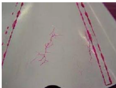
Рис. 6.1. Дефекти, що виявлені капілярним методом контролю
