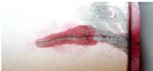
Рис. 6.3. Вигляд дефекту на поверхні після нанесення проявника
