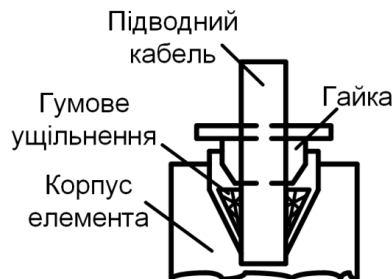
Рис. 2. Схема конструкції гермовводу
