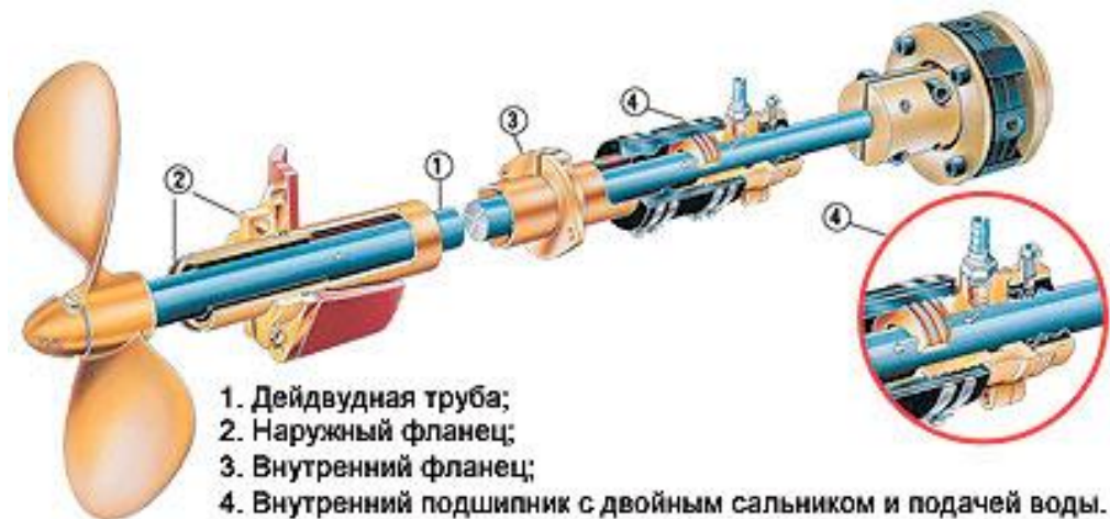
Рис. 2.5 - Схема кормової частини валопроводу
