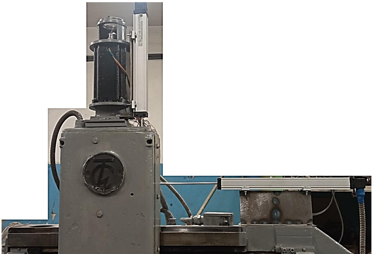
Рис. 3.14. Розташування крокового двигуна та лінійки вимірювання переміщення по осі Z (праворуч встановлена лінійка вимірювання переміщення по осі Y).
