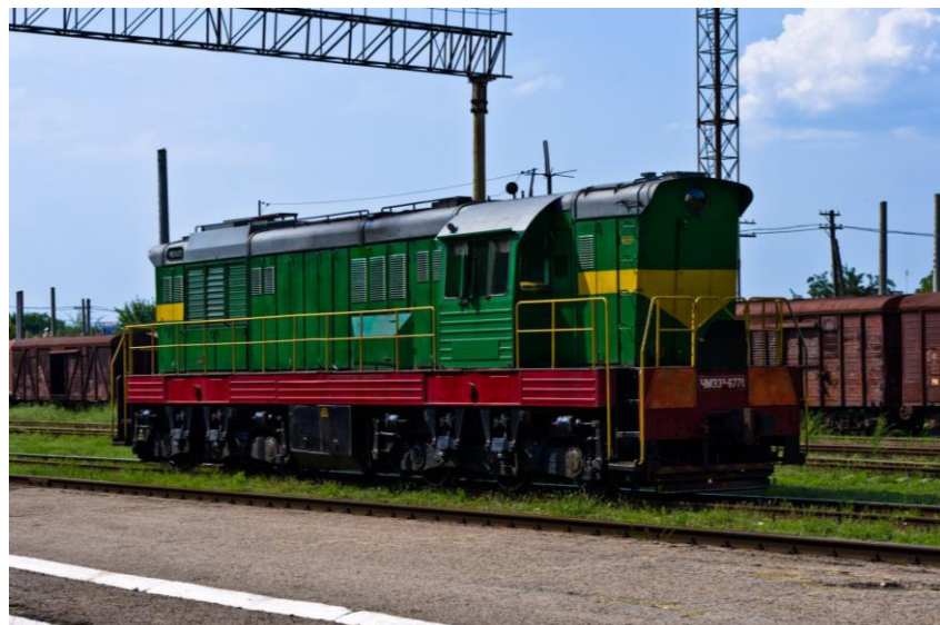
Рисунок 1.1 - Маневровий тепловоз ЧМЕЗ-6771 на залізничній станції
