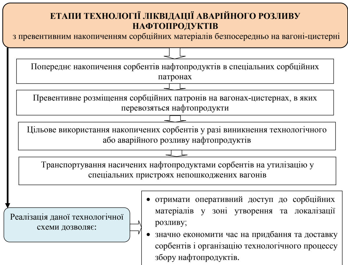
Рис. 3.3 – Етапи запропонованої технології ліквідації аварійного розливу нафтопродуктів
