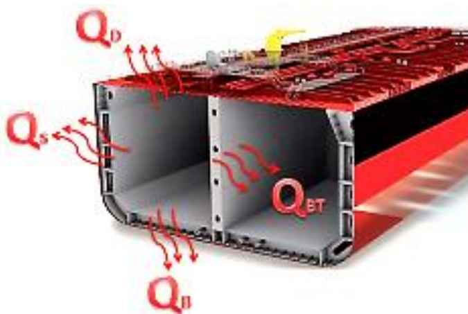
Рисунок 2.2. Теплові потоки через поверхні вантажного танка танкера
