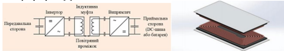
Рисунки 2.1. Структурна схема індуктивної зарядної системи і конструкція котушок
