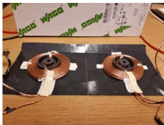
Рисунок 4.2. Передатвальна та приймальна котушки з Litz-дроту
