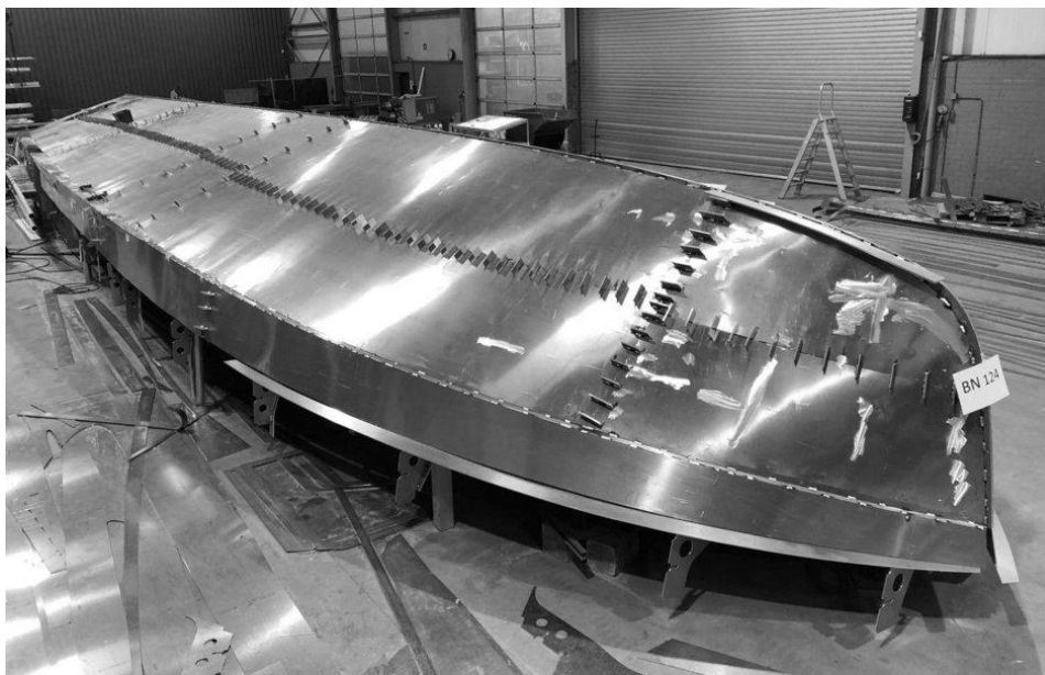
Рис.2.1. Виготовлення корпусу з алюмінію моторної яхти на виробництві.
