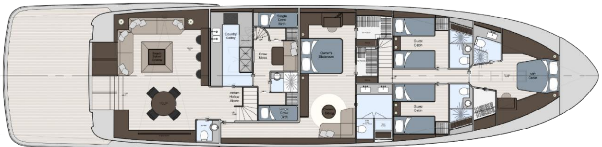
Рис.2.4. План нижньої палуби з головним салоном в кормовій частині судна.
