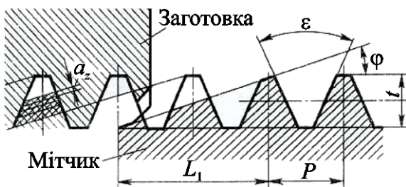
Рис. 70. Схема нарізування різьби мітчиком
