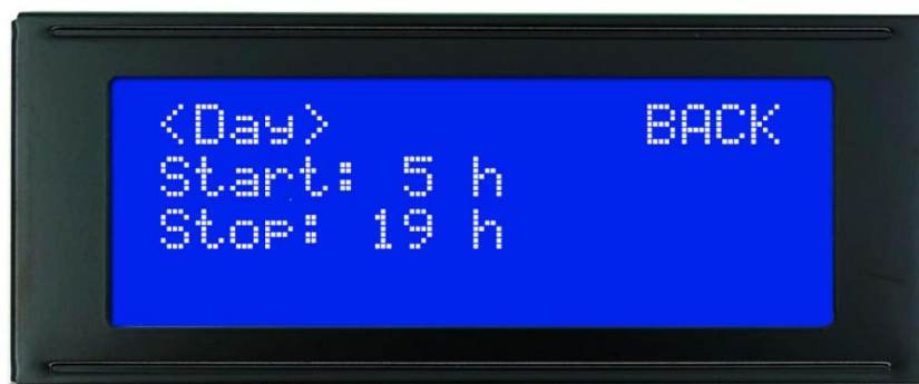
Рисунок 3.5 – Екран налаштування режиму Day: час початку та завершення
