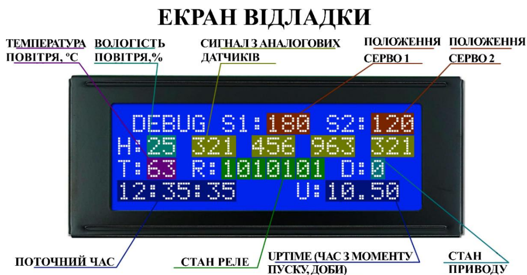
Рисунок 3.2 – Екран відладки: варіант з роздільним відображенням Н/Т
