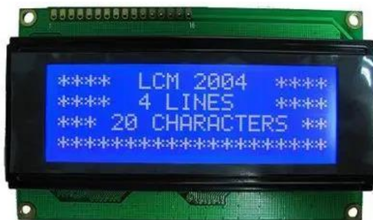
Рисунок 2.2 – Рідкокристалічний дисплей LCD2004 формату 20 символів на 4 рядки
