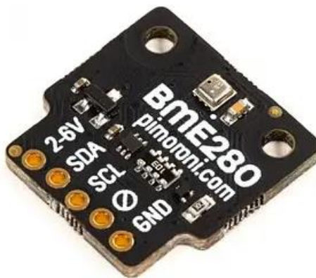
Рисунок 1.7 – Датчик температури та вологості BME280 виробництва Bosch Sensortec
